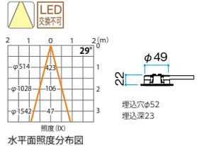
ローボルトタイプの浅型LEDダウンライトです。庇の本体厚(25mm・60mm)の中にすっきりと納まり、照明器具の外径もφ62mmと小型です。点灯用の専用トランス(電源装置)は屋外設置にも対応し、センサーやタイマー機能を備えたモデルもあります。様々な利用シーンに応じた使い分けが可能です。庇本体への照明器具の取付けは、板ばねを使ったワンタッチタイプなので施工も簡単です。
